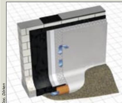
En présence de terres imperméables, la protection de vos soubassements sera d'autant mieux assurée par l'emploi d'une membrane noppée sur laquelle est **thermosoudée une natte filtrante** (géotextile)
