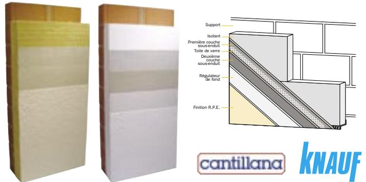
L'élément essentiel de la mise en œuvre étant de combiner le collage à une fixation mécanique sur le support.
